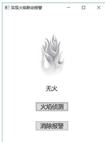
当检测到火焰报警后，点击“消除报警”按钮（意味着火焰警报已经消除了），则 N/A 显示“无火”，火焰图片变成灰色，熄灭报警灯，消去 LED “着火”显示。
